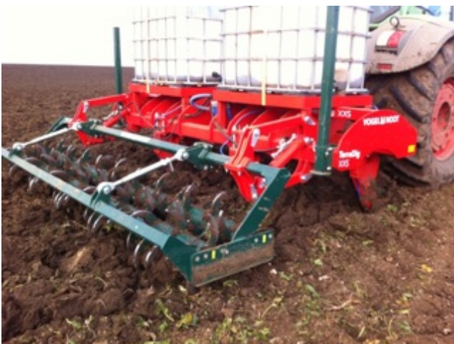
Bodenbearbeitung und Tiefenlockerung in Rumänien unter gleichzeitiger Einbringung von Mikroturen Quelle: BioMaProNatur GmbH
